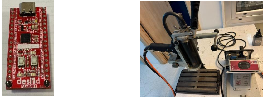
Şekil 4. Test için kaplama yapılan Devre kartı ve düşük basınçlı plastik enjeksiyon cihazı
