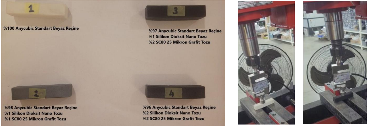
Şekil 6. Test parçaları ve basınç altında kırılma test düzeneği
