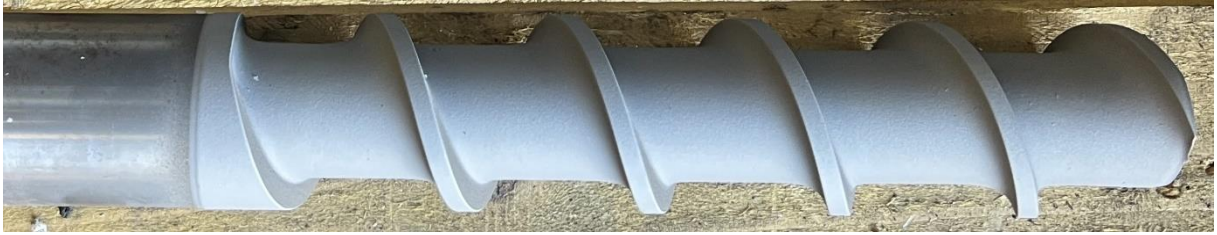
Şekil 1.b : HVOF yöntemiyle molibden kaplama
