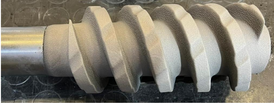
Şekil 1.a : WFS yöntemiyle molibden kaplama
