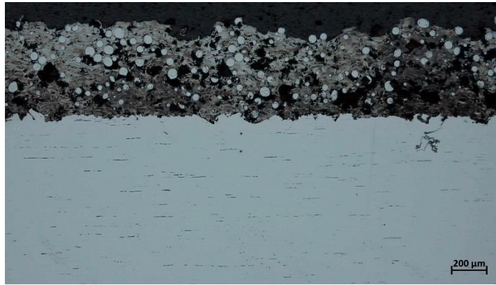
Şekil 2.f : PFS Mo kaplanmış numunenin kesit alanı görüntüsü
